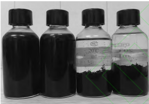
从左至右热解时间依次为 0.5, 5, 20, 40 min 制备的石墨烯,经超声分散于二甲基甲酰胺(DMF)中放置 1 个月。
