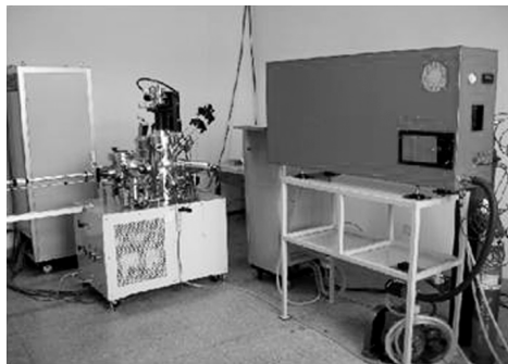
图 1 PLD-301 型脉冲激光沉积装置
